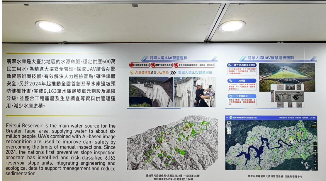
圖 4：翡翠大壩 UAV 智慧巡檢系統
